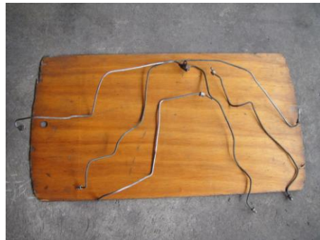
Fig. 2,9 Cañerías de acero utilizadas
