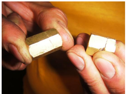
Fig. 5.3 Niplos con Fisuras
