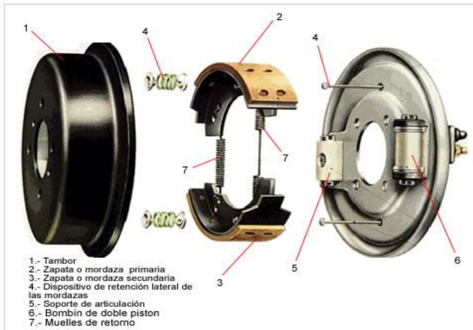
Fig. 1.20 Despiece de los frenos de tambor 8
