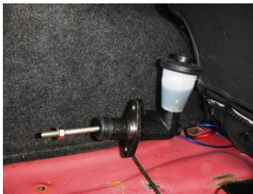
Fig. 2.2 Bomba auxiliar ubicada en el porta maletas del Vehículo
