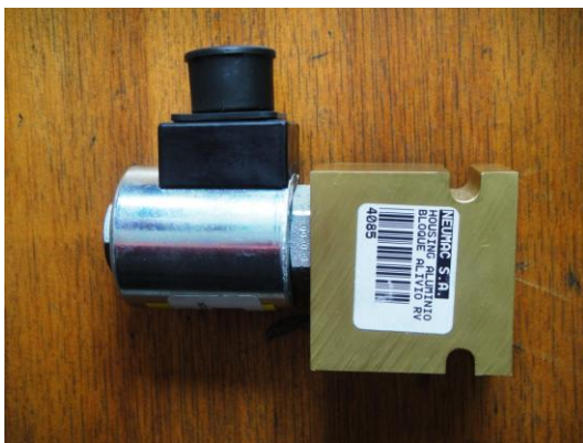
Fig. 2.4 Válvula Eaton Vickers SV3-10-C
