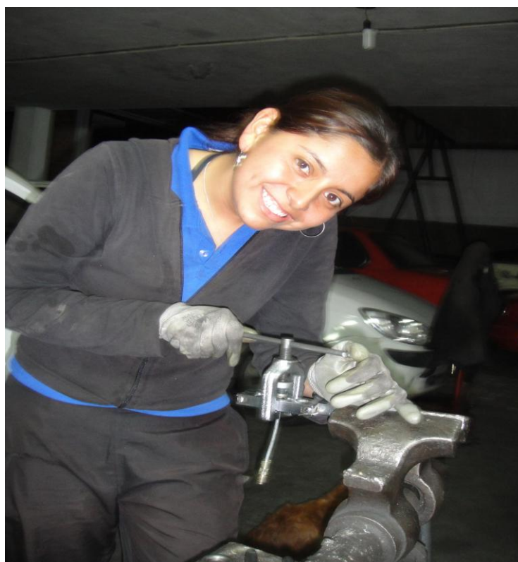
Fig. 2.11 Procedimiento para la realización del cono en las cañerías de frenos a ser utilizadas
