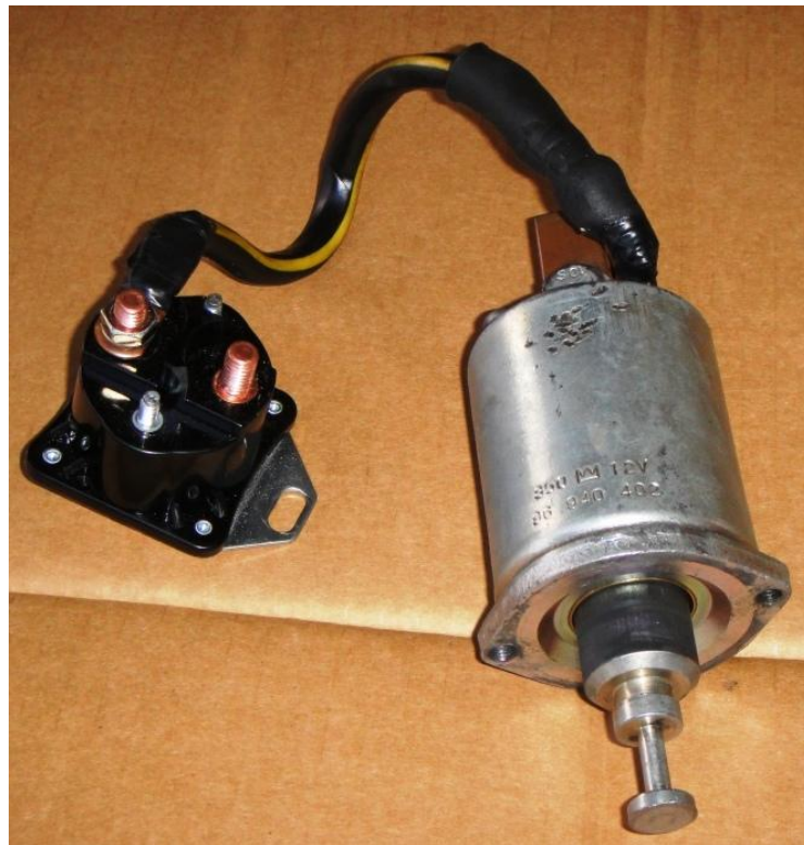
Fig.4.4 Solenoide de arranque y Automático auxiliar de arranque utilizados
