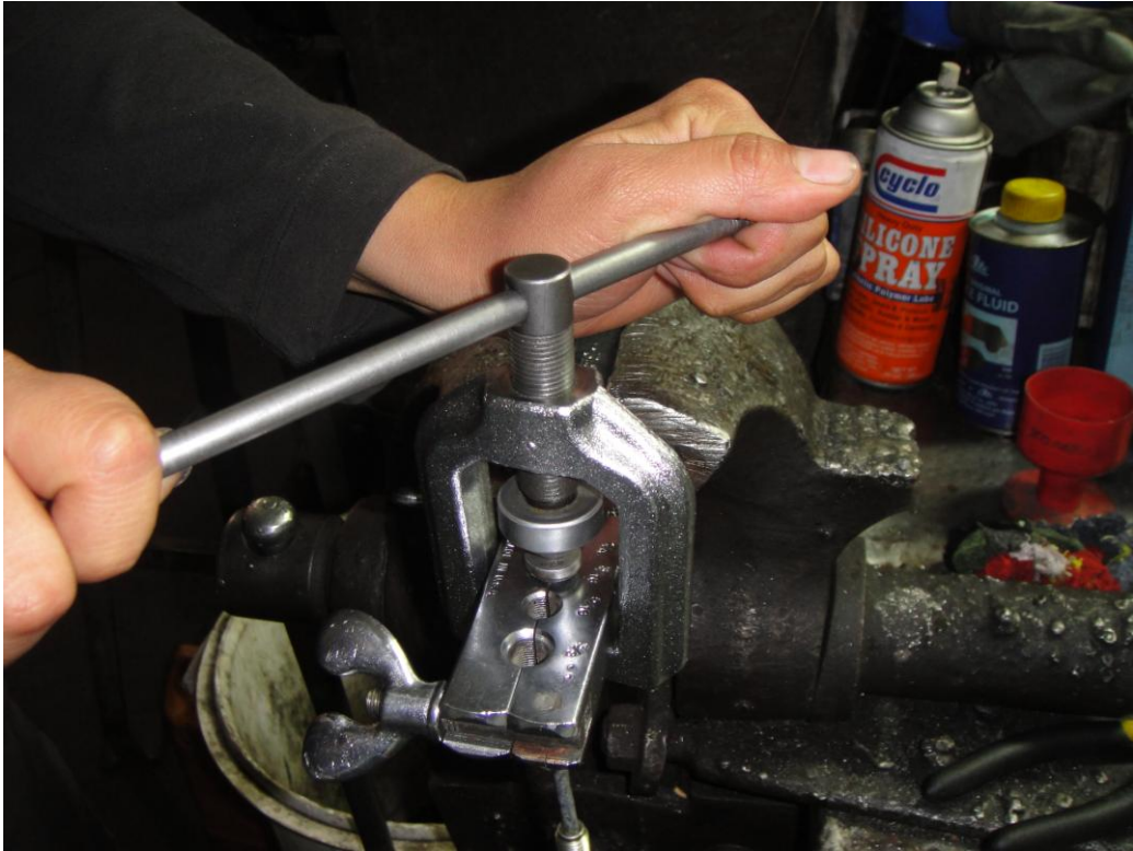
Fig.2.12 Herramienta utilizada para la realización del cono en las cañerías
