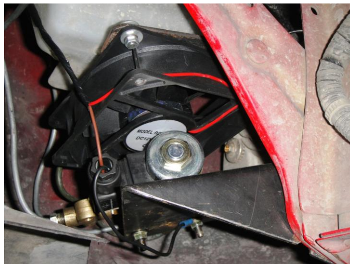
Fig. 3.8 Ventilador para evitar recalentamiento de bobina de válvula
