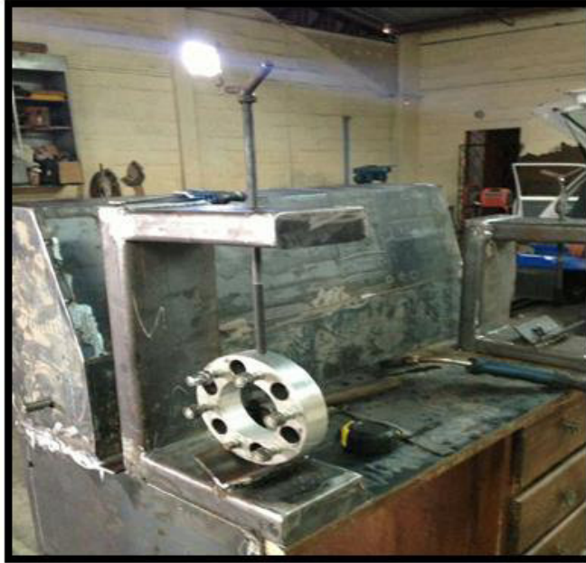
Figura 3. 5 Foto de las partes en V para hacer girar la varilla roscada
