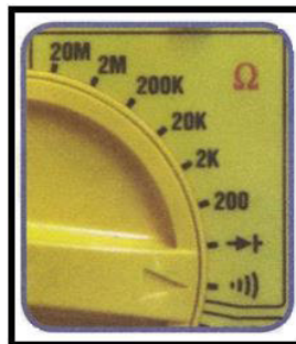
Figura 2. 10 Multímetro en la opción de continuidad
