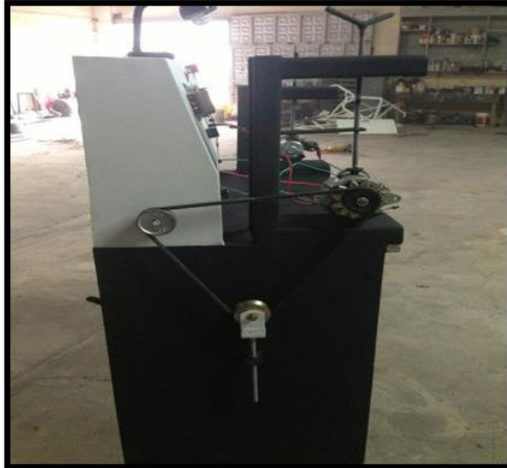
Figura 3. 7 Foto del motor eléctrico y las poleas utilizadas para su adecuación con el alternador
