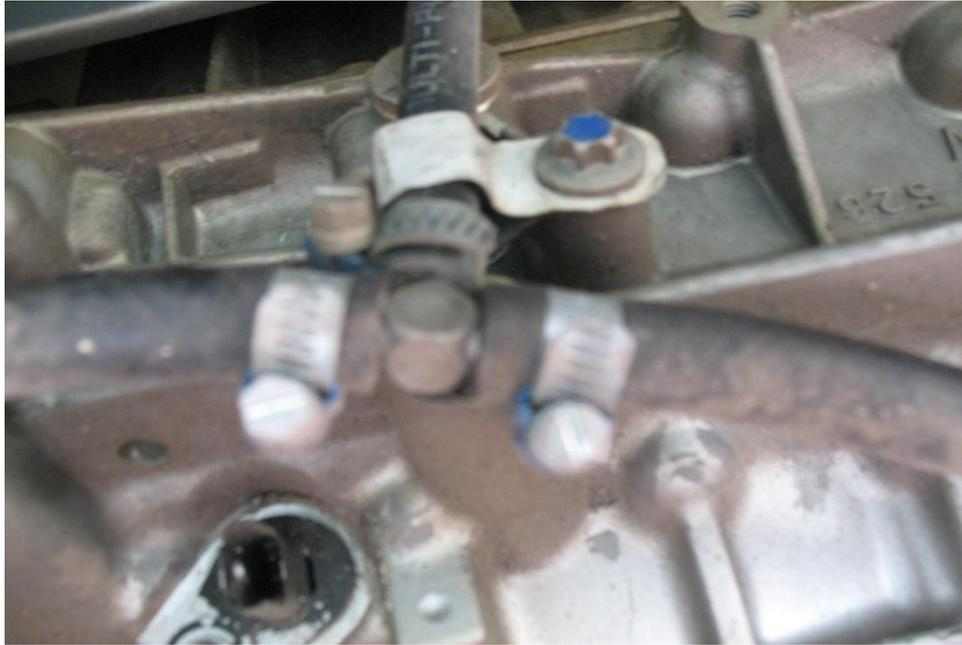
Figura 3.15 Conexión Hidráulica para Adaptación de Manómetro
