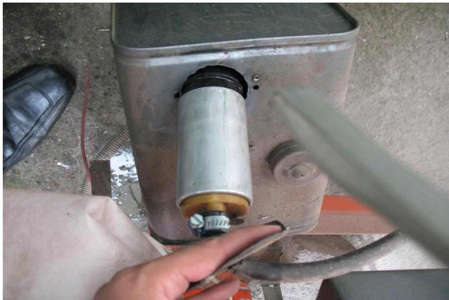
Figura 3.14 Bomba de Combustible de Baja Presión
