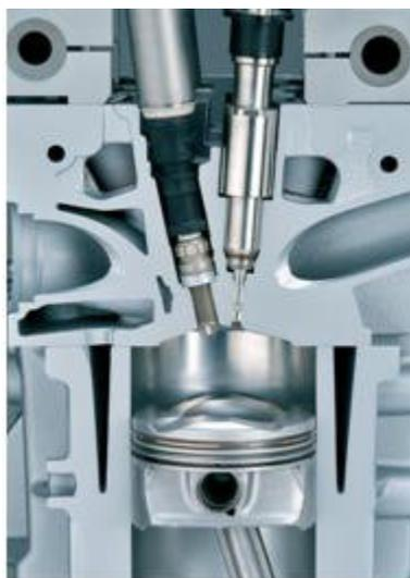
Figura 2.6 Cámara de Combustión<sup>17</sup>
