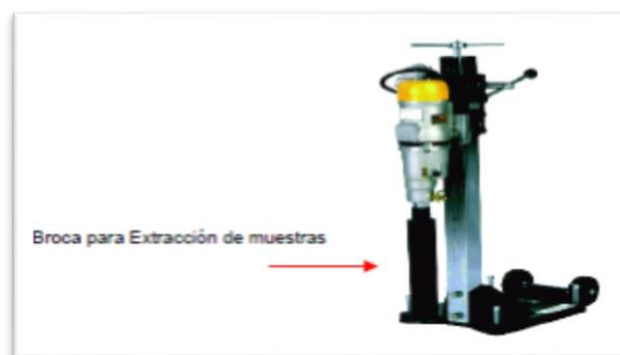
Figura 17 Equipo para extracción de núcleos de capas asfálticas
