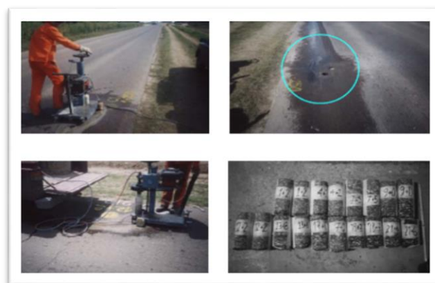
Figura 18 Toma de núcleos de capas asfálticas
