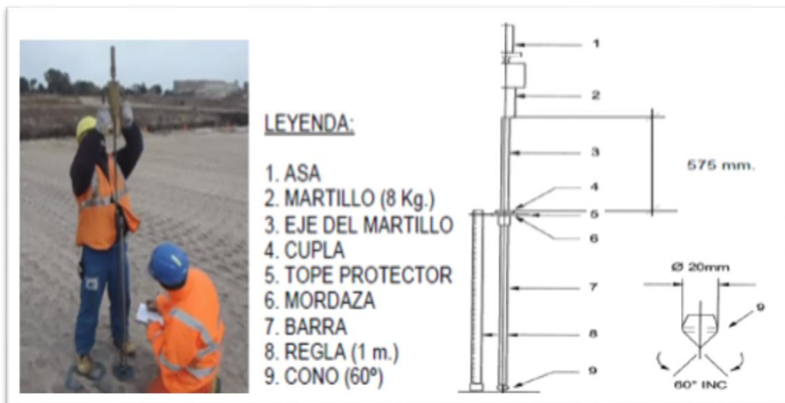
Figura 23 Esquema General del DCP
