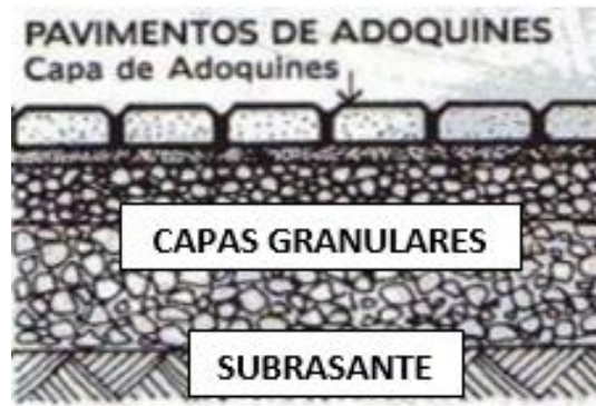
Figura 3 Sección de Pavimento Articulado
