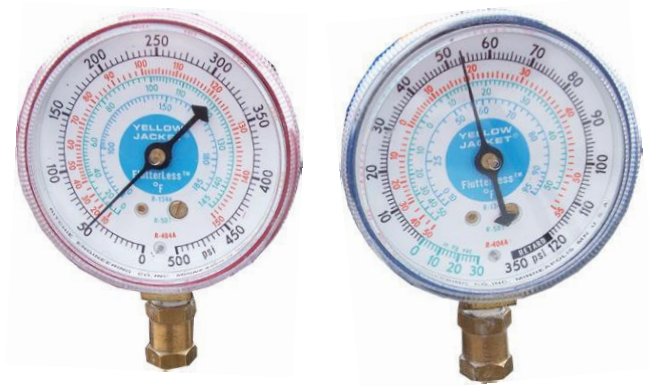
Figura 3.10. Manómetros de alta y baja presión marca YELLOW JACKET
