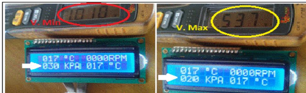
**Figura 4.20.** Verificación Potenciómetro del Sensor MAP
