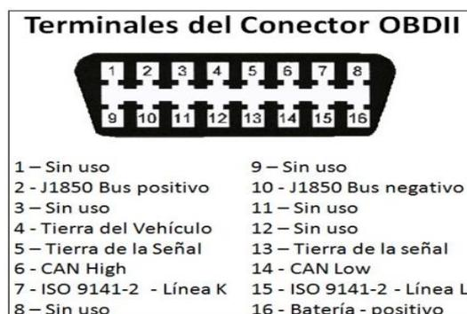
**Gráfico 1.2.** Terminales del Conector OBDII
