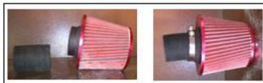
**Figura 4.5 Instalación de acople para filtro de aire**
