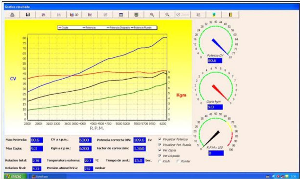
Figura 4.24 Resultados de potencia con vehículo modificado la fase del árbol de levas
