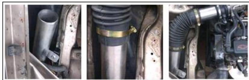
**Figura 4.10 Instalación y conexión de mangueras de filtro de aire**
