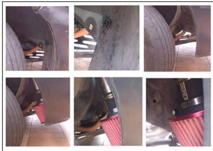
**Figura 4.7 Instalación de filtro de aire en el vehículo**
