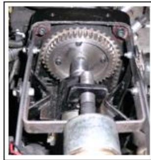
**Figura 4.16 Instalación de pernos en la base posterior a la polea variable**
