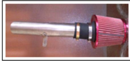
**Figura 4.6 Instalación de tubo con filtro de aire**
