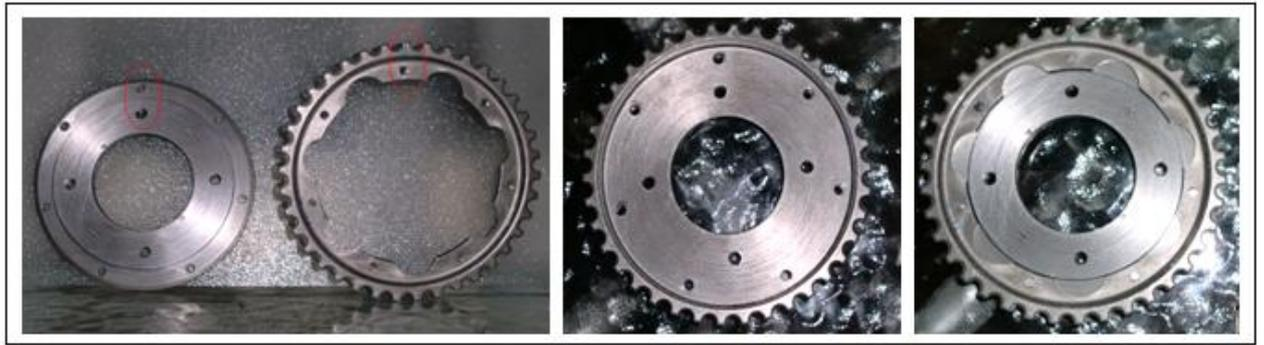
**Figura 3.38 Ensamblaje polea variable**
