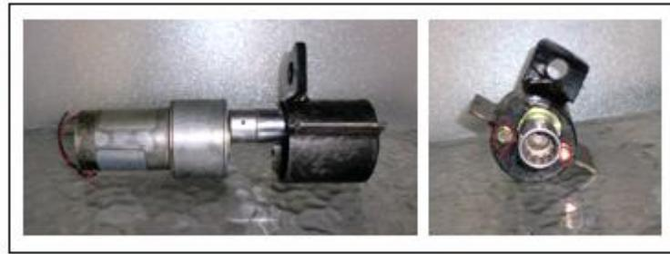
**Figura 3.45 Ensamblaje de motor DC con dado y base.**
