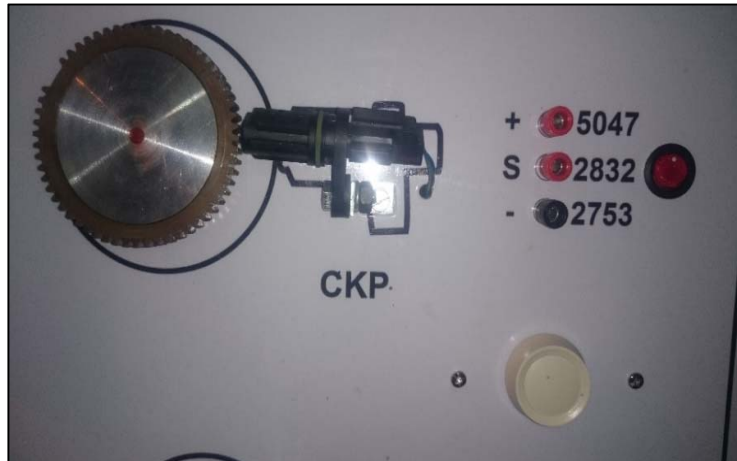
Figura 20. Montaje del sensor CKP Autor: Rodolfo Mera
