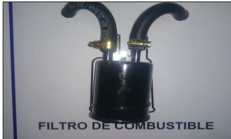
Figura 35. Montaje del filtro de combustible Autor: Rodolfo Mera
