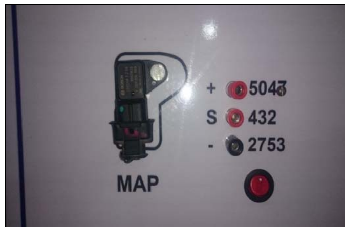
Figura 14. Instalación de lo sensor MAP Autor: Rodolfo Mera
