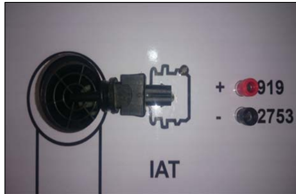
Figura 46. Sensor de temperatura de aire del motor Autor: Rodolfo Mera
