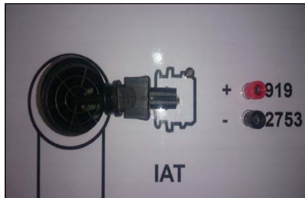
Figura 12. Instalación de lo sensor IAT Autor: Rodolfo Mera
