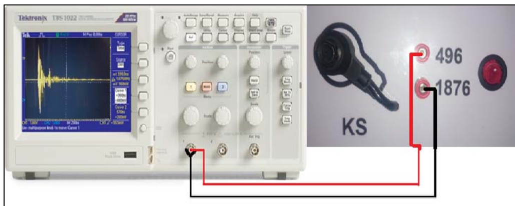
Figura 59. Conexión del osciloscopio en el sensor KS Autor: Rodolfo Mera
