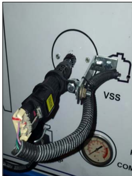
Figura 22. Montaje del sensor VSS Autor: Rodolfo Mera
