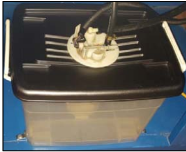
Figura 33. Montaje de la bomba de combustible Autor: Rodolfo Mera
