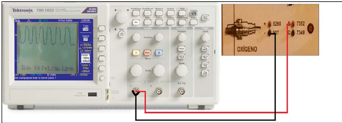
Figura 53. Conexión del osciloscopio en el sensor de oxígeno Autor: Rodolfo Mera
