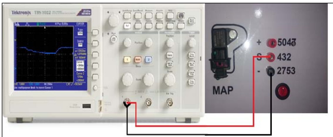
Figura 51. Conexión del osciloscopio en el sensor MAP Autor: Rodolfo Mera
