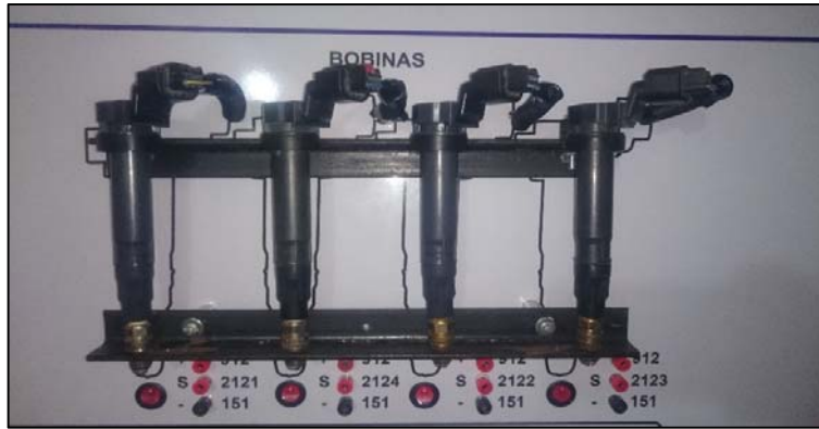
Figura 16. Montaje del conjunto de bobinas Autor: Rodolfo Mera
