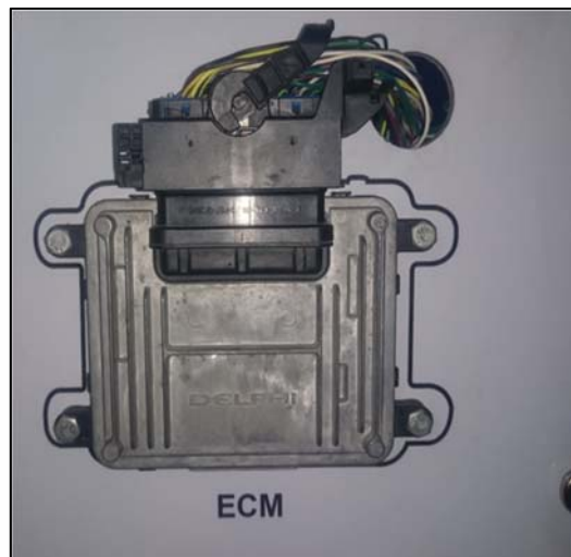
Figura 5. Instalación del módulo de control electrónico Autor: Rodolfo Mera.
