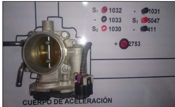
Figura 8. Montaje del cuerpo de aceleración Autor: Rodolfo Mera
