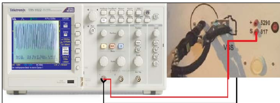
Figura 57. Conexión del osciloscopio en el sensor VSS Autor: Rodolfo Mera
