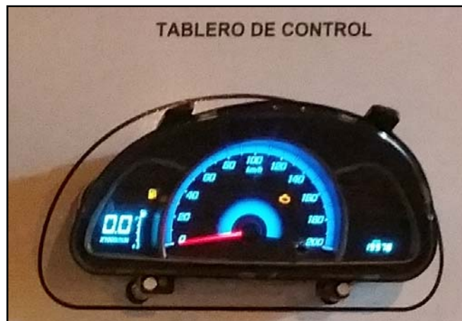
Figura 6. Instalación del tablero de instrumento Autor: Rodolfo Mera
