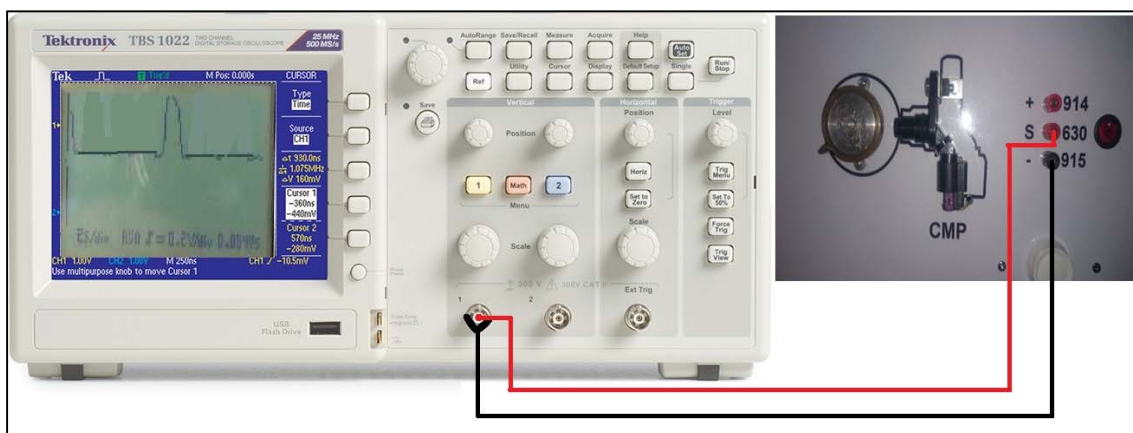
Figura 55. Conexión del osciloscopio en el sensor CMP Autor: Rodolfo Mera
