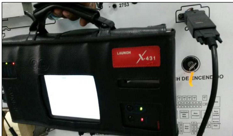
Figura 67. Conexión del scanner Launch X-431 al OBDII Autor: Rodolfo Mera
