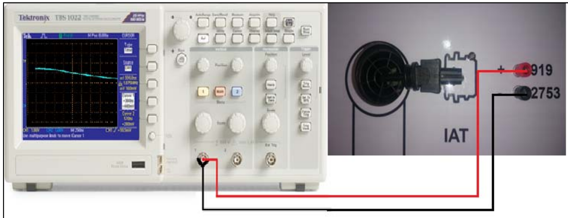
Figura 47. Conexión del osciloscopio en el sensor IAT Autor: Rodolfo Mera
