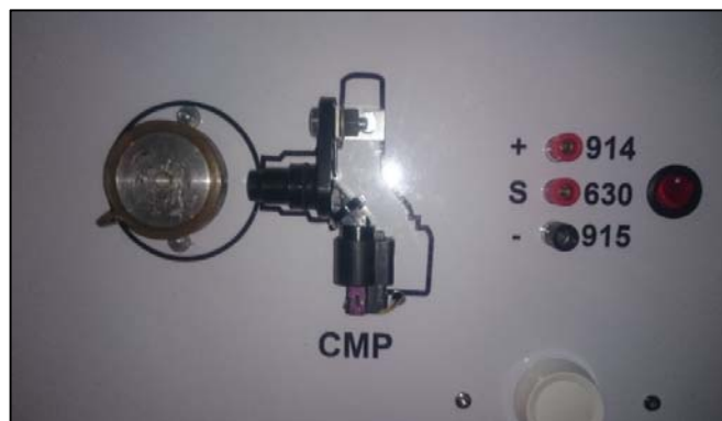
Figura 18. Montaje del sensor CMP Autor: Rodolfo Mera
