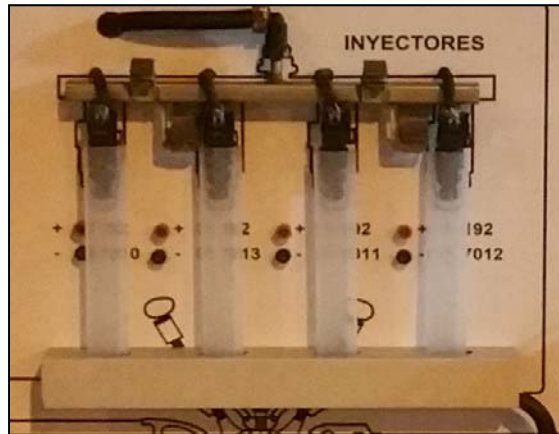
Figura 31. Montaje del riel de inyectores Autor: Rodolfo Mera
