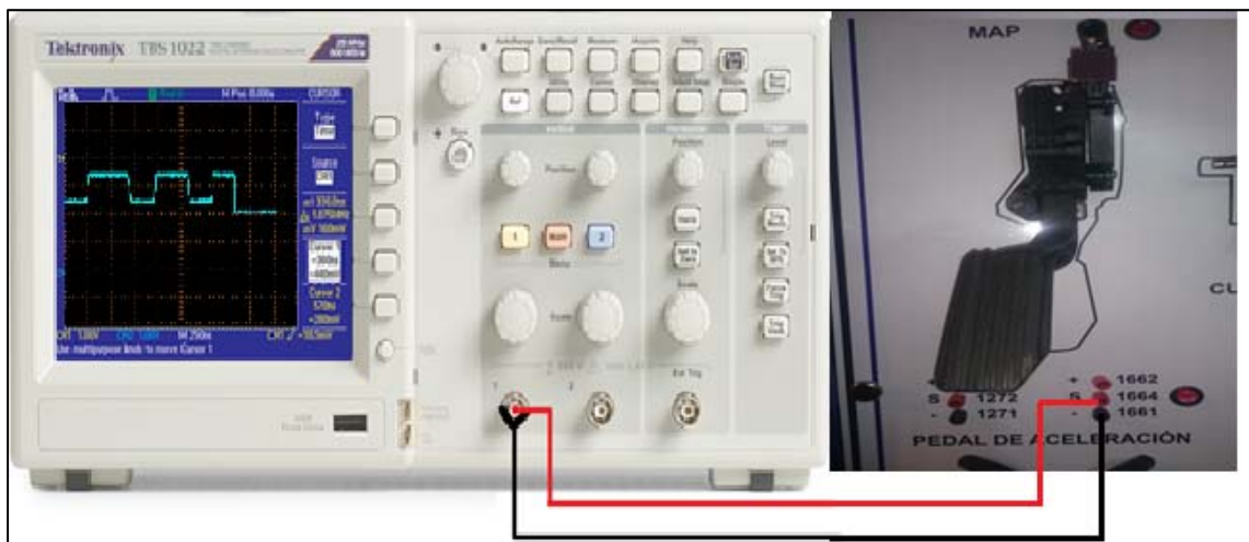
Figura 49. Conexión del osciloscopio en el pedal de aceleración Autor: Rodolfo Mera
