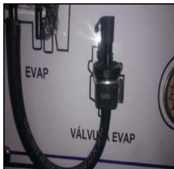
Figura 41. Montaje de la válvula EVAP Autor: Rodolfo Mera
