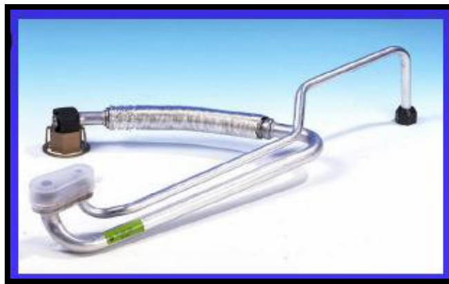
FIGURA 2.38 TUBO DE ALUMINIO FUENTE: MANUAL DEL SISTEMA DEL AIRE ACONDICIONADO DEL VEHÍCULO, SECAP
