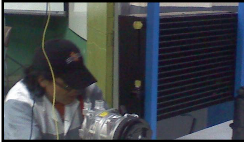
FIGURA 3.35 FIJACIÓN DEL CONDENSADOR FUENTE: DÍAZ, MANJARREZ
