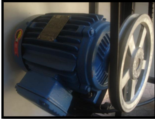
FIGURA 3.1 MOTOR TRIFÁSICO FUENTE: DÍAZ, MANJARREZ
