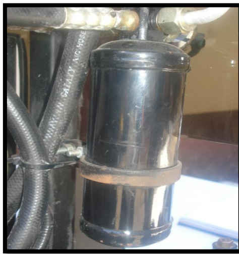
FIGURA 3.13 DEPÓSITO DE LÍQUIDO REFRIGERANTE FUENTE: DÍAZ, MANJARREZ
