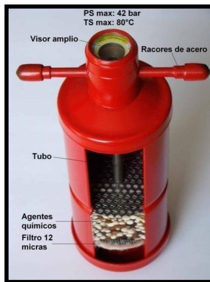
FIGURA 2.29 PARTES DEL FILTRO DESHIDRATADOR
