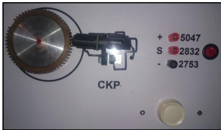
Figura 43. Instalación del sensor de posición del cigüeñal Autor: Jonathan Olivo
