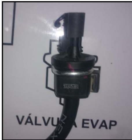
Figura 46. Instalación de la válvula EVAP Autor: Jonathan Olivo
