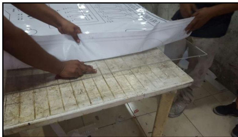
Figura 23. Pegado del vinilo sobre la lamina de acrílico Autor: Jonathan Olivo
