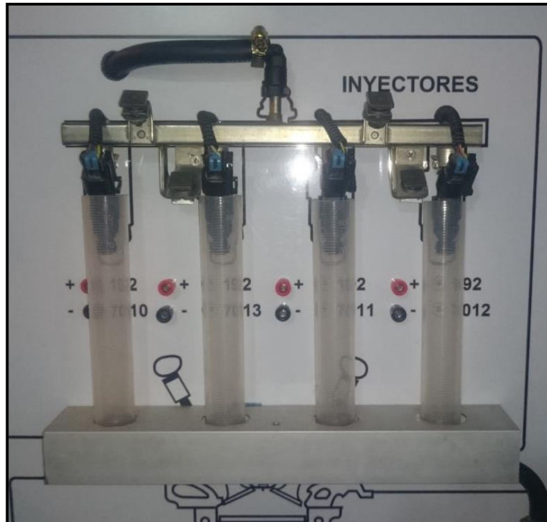
Figura 74. Inyectores de combustible Autor: Jonathan Olivo
