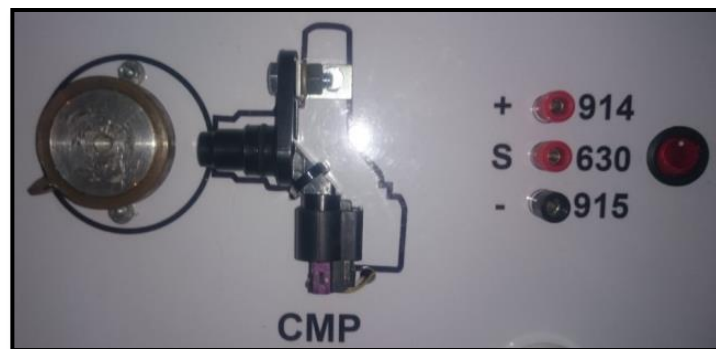
Figura 31. Instalación del sensor de posición del árbol de levas Autor: Jonathan Olivo
