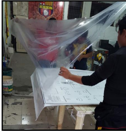
Figura 24. Pegado de la lámina protectora sobre el vinil Autor: Jonathan Olivo
