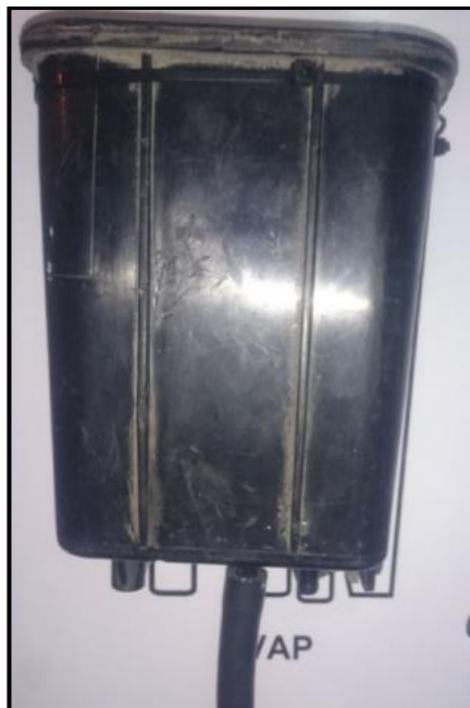
Figura 47. Instalación del EVAP Autor: Jonathan Olivo
