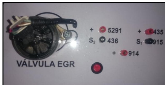
Figura 40. Instalación de la válvula EGR Autor: Jonathan Olivo
