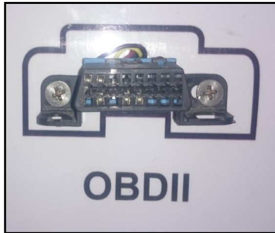
Figura 37. Instalación del Puerto OBDII Autor: Jonathan Olivo
