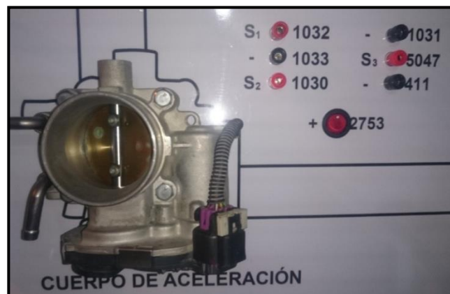
Figura 28. Instalación del cuerpo de aceleración electrónico Autor: Jonathan Olivo
