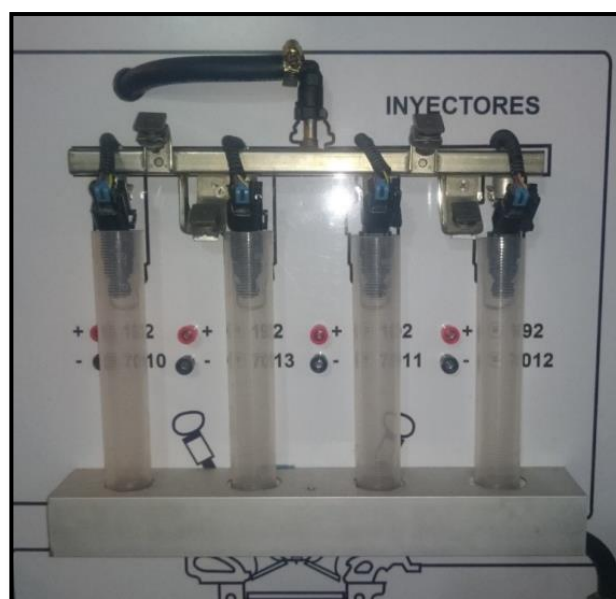
Figura 42. Instalación de los inyectores de combustibles Autor: Jonathan Olivo
