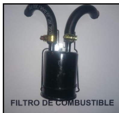
Figura 30. Instalación del filtro de combustible Autor: Jonathan Olivo
