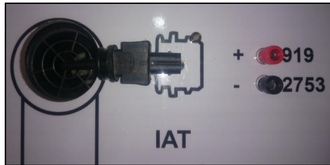
Figura 27. Montaje del sensor IAT Autor: Jonathan Olivo
