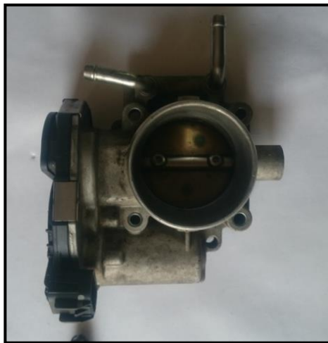
Figura 10. Sensor de posición del acelerador Autor: Jonathan Olivo
