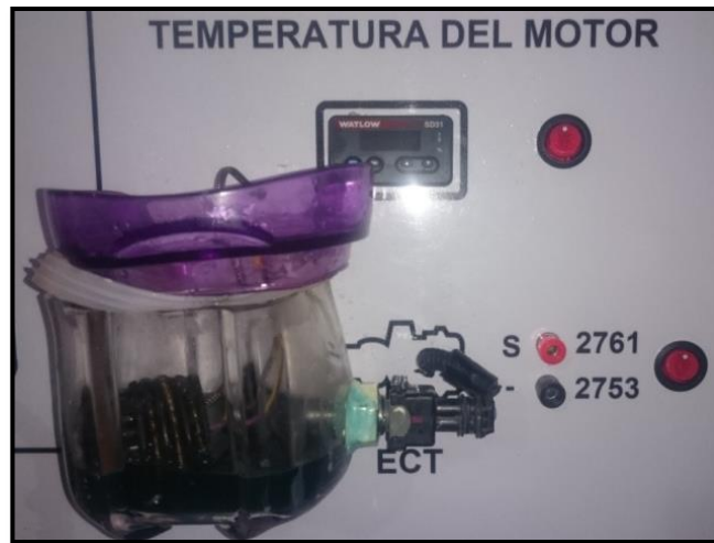
Figura 35. Instalación del sensor de temperatura Autor: Jonathan Olivo
