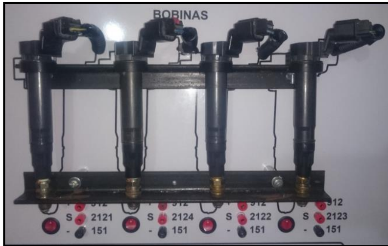
Figura 32. Instalación de las bobinas de encendido Autor: Jonathan Olivo
