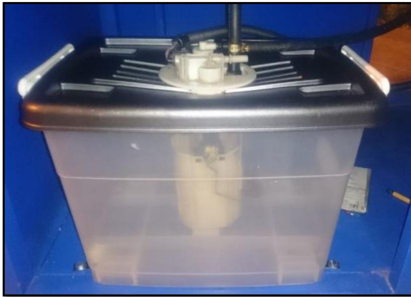
Figura 48. Instalación del tanque y bomba de combustible Autor: Jonathan Olivo
