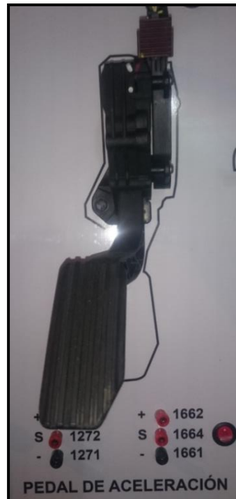
Figura 29. Instalación del pedal de aceleración Autor: Jonathan Olivo
