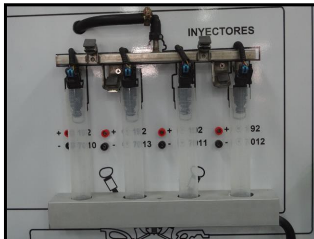
Figura 56. Instalación de los inyectores
