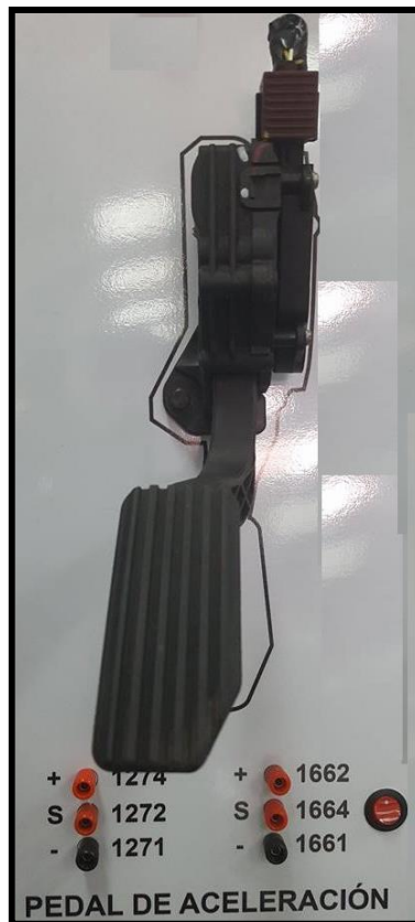
Figura 34. Instalación del pedal del acelerador
