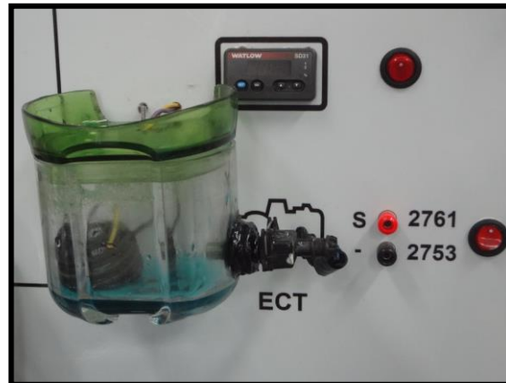
Figura 48. Instalación del sensor ECT
