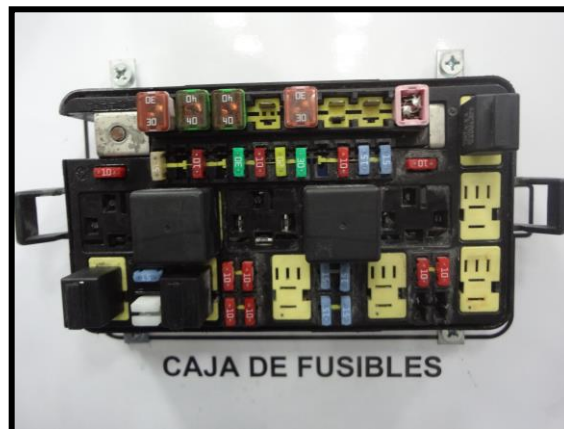
Figura 64. Instalación de la caja de fusibles
