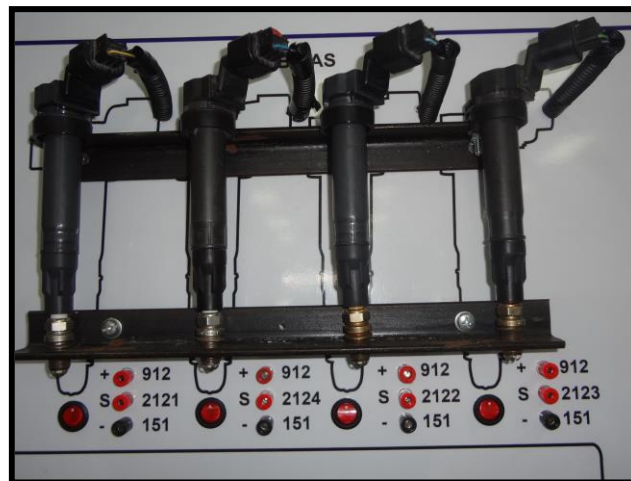
Figura 54. Instalación de las bobinas
