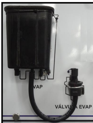
Figura 68. Instalación de la válvula del evap
