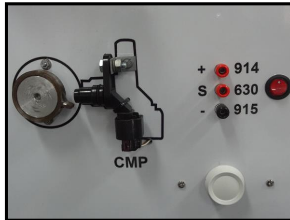
Figura 40. Instalación del sensor del CMP
