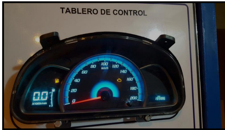
Figura 31. Instalación del tablero de instrumentos
