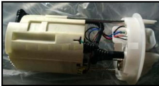
Figura 16. Bomba de combustible
