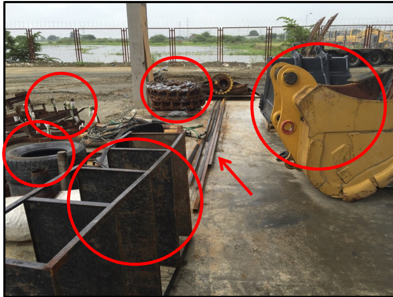
Figura N° 12. Desorden y falta de limpieza Fuente: Taller DITECA S.A. Editado por: Mauricio Torres
