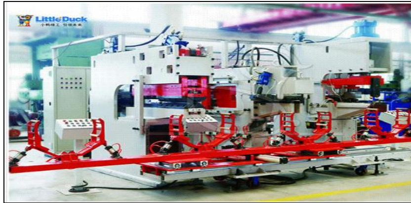
Figura 3.4. Máquina de desbarbado, aplanado y corte de extremos.
