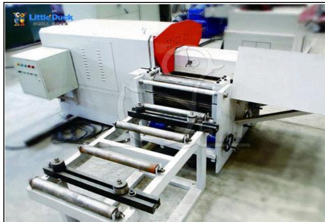
Figura 3.2. Máquina de Alimentación de Láminas de acero
