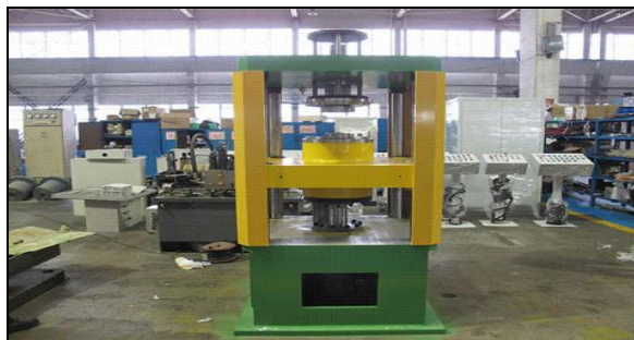
Figura 3.9. Prensa de disco y aro Fuente: SHANDONG XIAOAYA. Steel Wheel Rim Manufacturing Line, Little Duck, 2015
