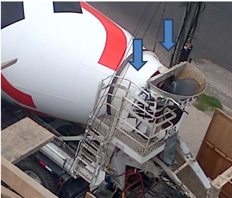
Figura 42: Camión transportador de hormigón
