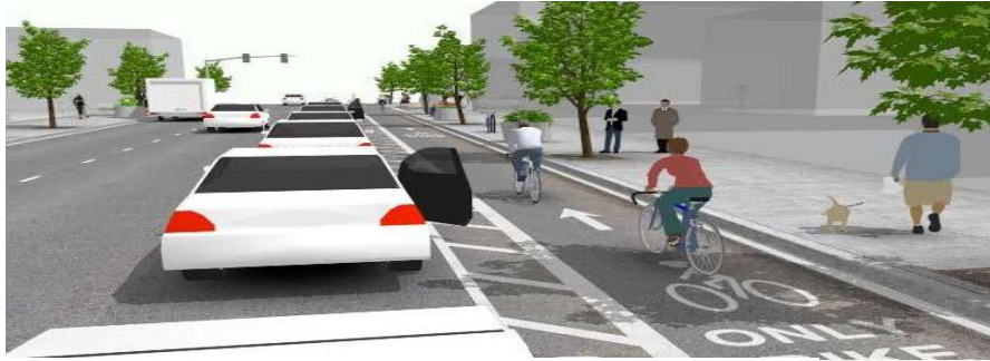
Figura 14. Señalización carril bicicleta con espacio de seguridad para apertura de puertas
