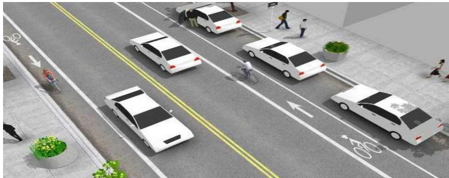
Figura 15. Señalización para carril bicicleta ubicado al lado derecho de la calzada
