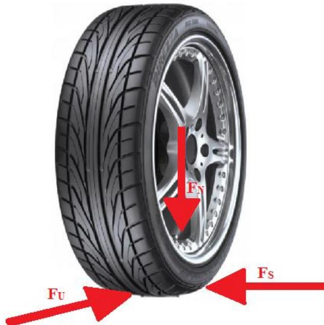
**Figura 1.9:** Componentes de las fuerzas del neumático
