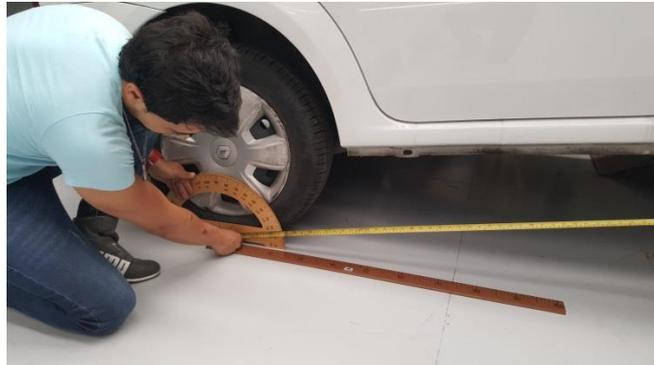
**Figura 3.4:** Ángulo de inclinación del vehículo ( $15^\circ$ )
