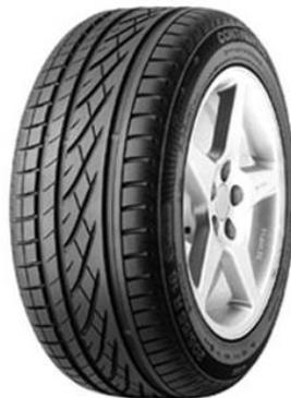
**Figura 1.6:** Neumático Asimétrico
