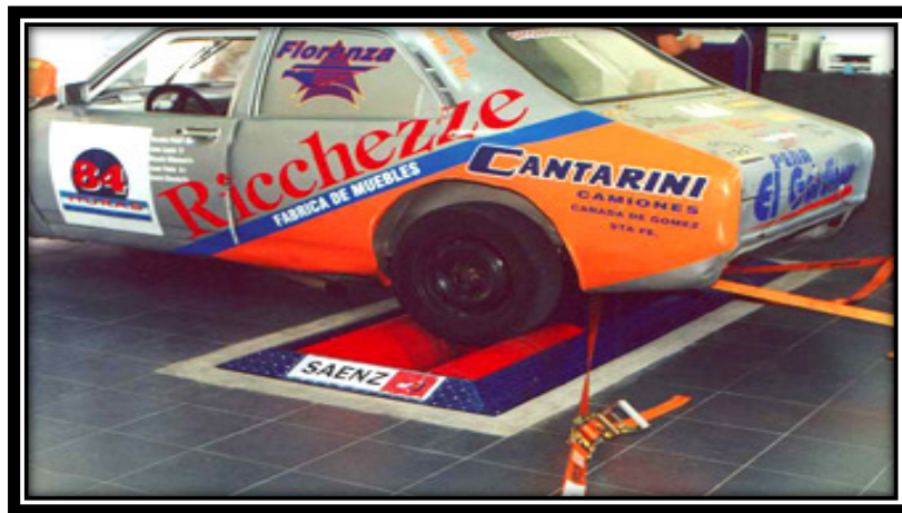
FIGURA 6 Dinamómetro de Chasis con tracción en dos ruedas.
