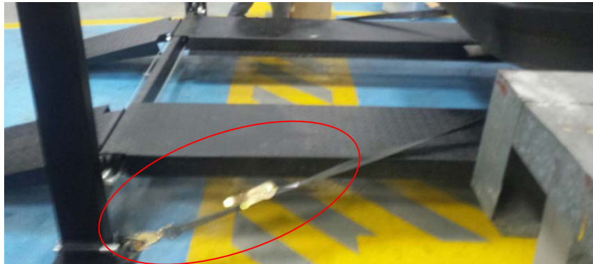
FIGURA 26 Anclaje de vehículos
