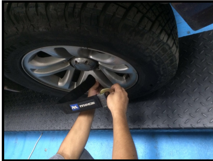
Figura 37. "Strapping" Anclaje Instalación De Fajas Modulo Frontal Vehiculo Propulsión. Fuente: Taller UIDE Extensión Guayaquil Campus Centro. Editado por: Thomas Ng.
