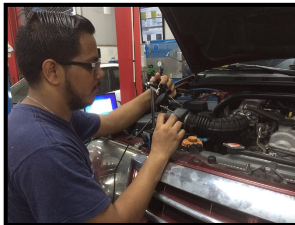
Figura 57. Ubicando Sensor Óptico Para Medición De Revoluciones. Fuente: Taller UIDE Extensión Guayaquil Campus Centro. Editado por: Thomas Ng
