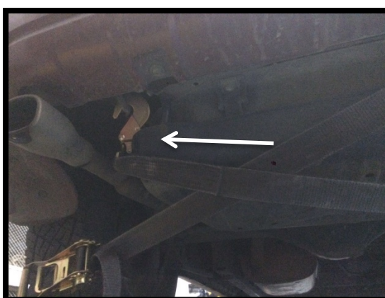
Figura 41. "Strapping" Anclaje Modulo Posterior Vehiculo a Propulsion. Fuente: Taller UIDE Extensión Guayaquil Campus Centro. Editado por: Thomas Ng.
