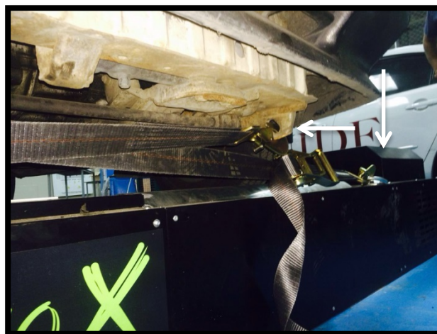
Figura 34. "Strapping" Anclaje Modulo Frontal Vehículo Tracción A Partes Fijas (Estructura del Dinamómetro). Fuente: Taller UIDE Extensión Guayaquil Campus Centro. Editado por: Thomas Ng.
