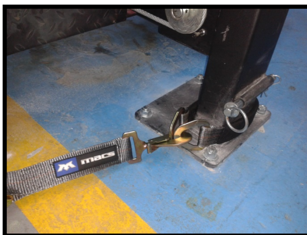
Figura 40. Partes Fijas "Strapping" Anclaje. Fuente: Taller UIDE Extensión Guayaquil Campus Centro. Editado por: Thomas Ng.
