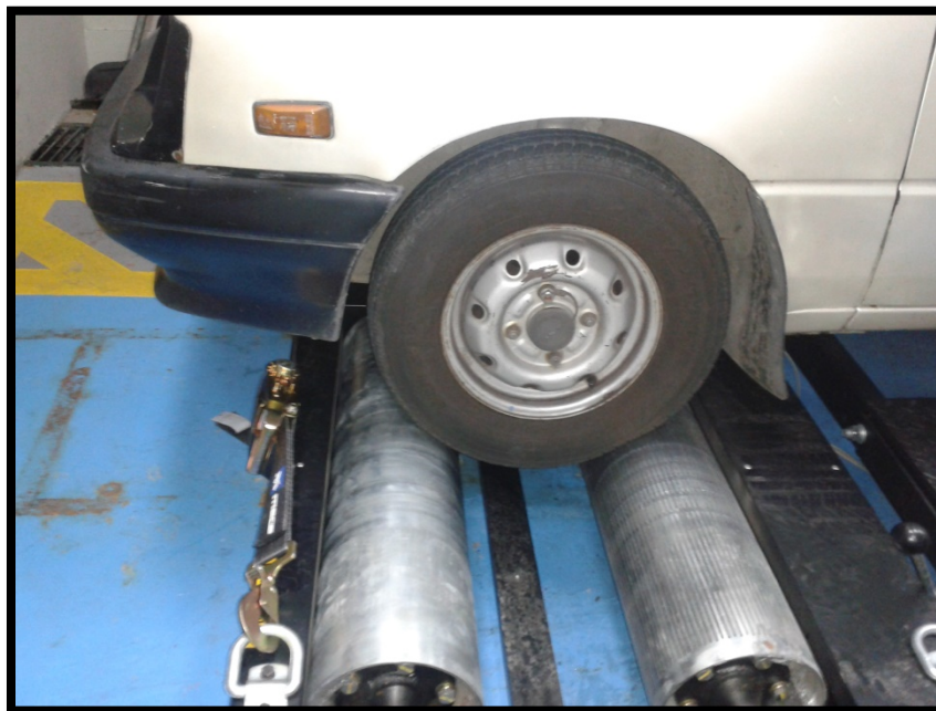
Figura 29. Posicionamiento Dentro De Los Rodillos Del Banco Dinamométrico Vehículo Tracción.
