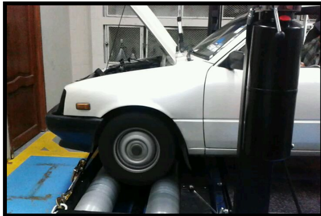
Figura 46. Marcha del vehículo y comprobación de correas ancladas. Fuente: Taller UIDE Extensión Guayaquil Campus Centro. Editado por: Thomas Ng.
