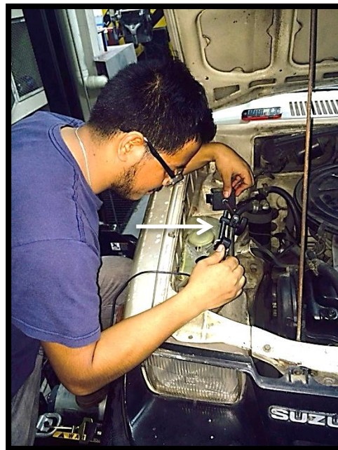
Figura 60. Ubicando Sensor De Revoluciones. Fuente: Taller UIDE Extensión Guayaquil Campus Centro. Editado por: Thomas Ng
