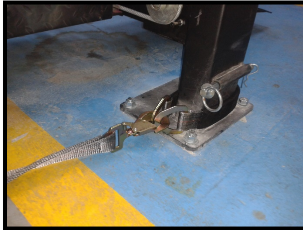
Figura 32. Partes Fijas "Strapping" Anclaje. Fuente: Taller UIDE Extensión Guayaquil Campus Centro. Editado por: Thomas Ng.
