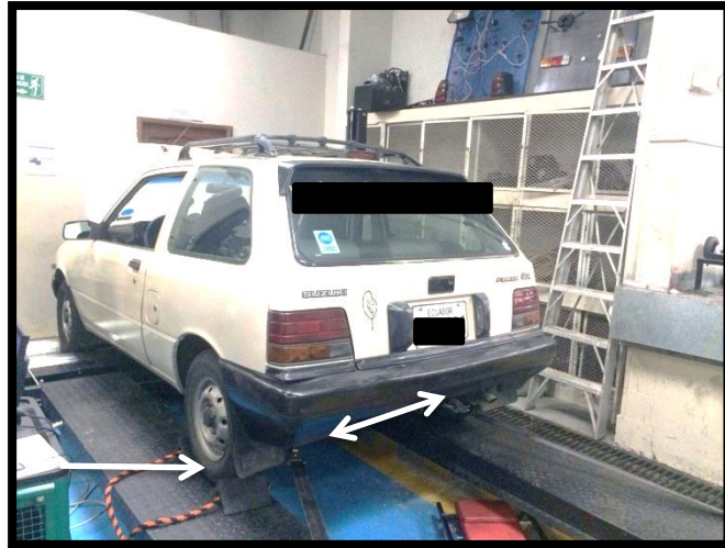
Figura 59. Colocación De Bloques En Ruedas No Motrices Y Anclaje Vehículo Tracción. Fuente: Taller UIDE Extensión Guayaquil Campus Centro. Editado por: Thomas Ng.
