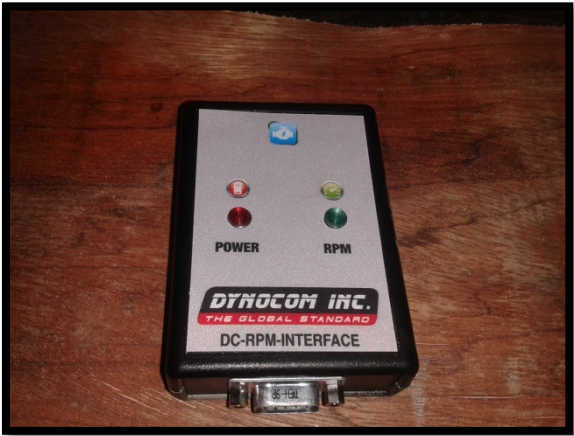
Figura 7. Módulo De Sensor Óptico Lector De Revoluciones RPM. Fuente: Taller UIDE Extensión Guayaquil Campus Centro. Editado por: Thomas Ng
