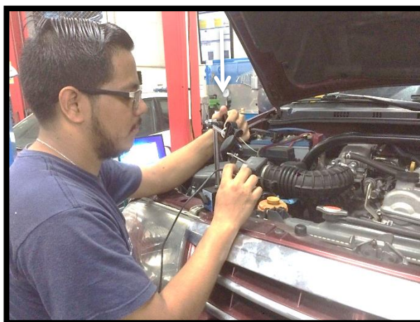
Figura 61. Ubicando Sensor de Revoluciones. Fuente: Taller UIDE Extensión Guayaquil Campus Centro. Editado por: Thomas Ng
