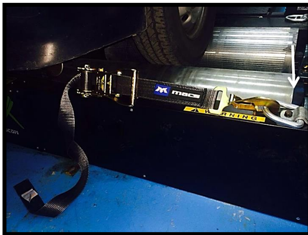
Figura 36. "Strapping" Anclaje Modulo Frontal Vehículo Tracción A Partes Fijas (Estructura del Dinamómetro).
