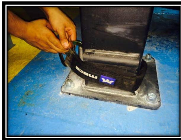
Figura 30. Colocación banda en poste trasero del elevador (rampas).
