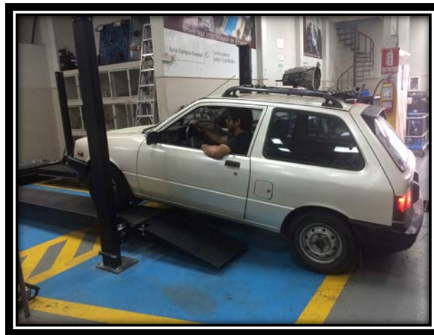
Figura 25. Entrada a rampa del dinamómetro.
