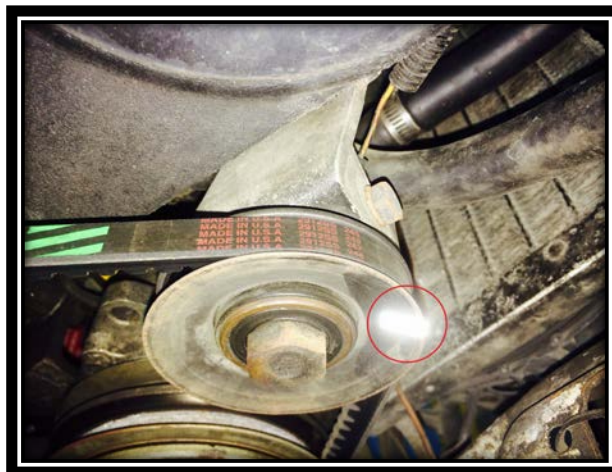
Figura 34. Colocación de sticker reflectivo en polea templadora.
