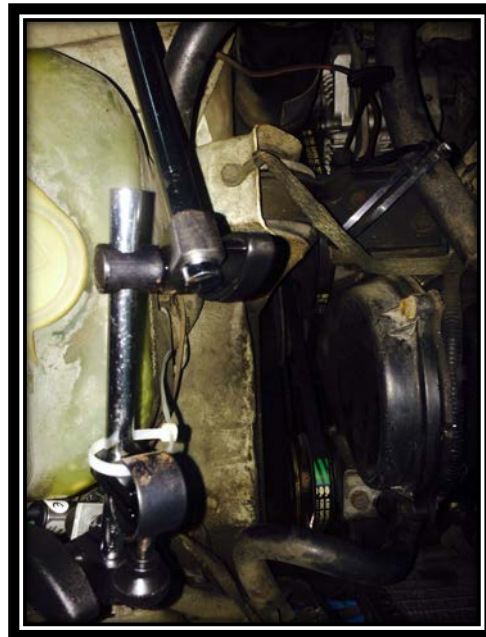
Figura 33. Sensor óptico colocado en motor.
