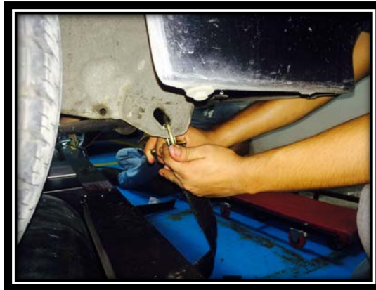
Figura 27. Colocación banda en chasis frontal del Suzuki.
