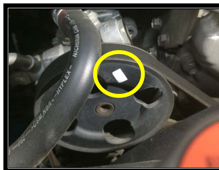
Figura 28. Colocación cinta reflectante
