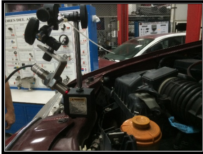
Figura 29. Colocación sensor óptico
