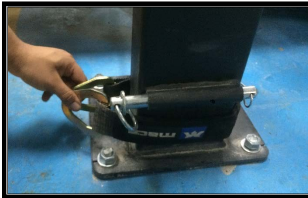
Figura 23. Colocación faja en poste
